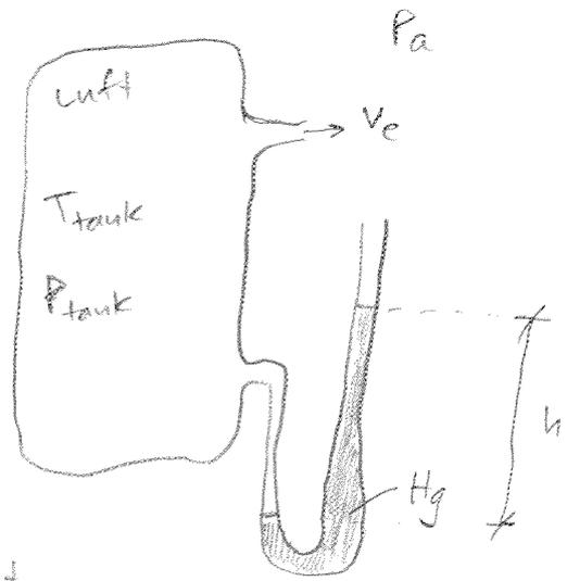
Lösning: (9.23)  $c_p T_0 = c_p T_e + \frac{1}{2} V_e^2$
