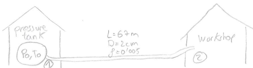
Data:  $M_2=1$ ;  $L=67\text{m}$ ;  $D=2\text{cm}$ ;  $T_0=288\text{K}$ ;  $P_0=10\text{ bar}$ ;  $f=0.005$
